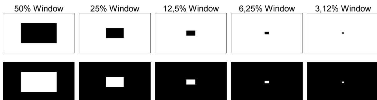
Diese Testbildsequenz ermöglicht das Erfassen und Quantifizieren des Kontrastumfangs im Relation zur Motivdetailgröße. Idealerweise bleibt der Kontrast unverändert gleich groß, unabhängig vom Motiv.
